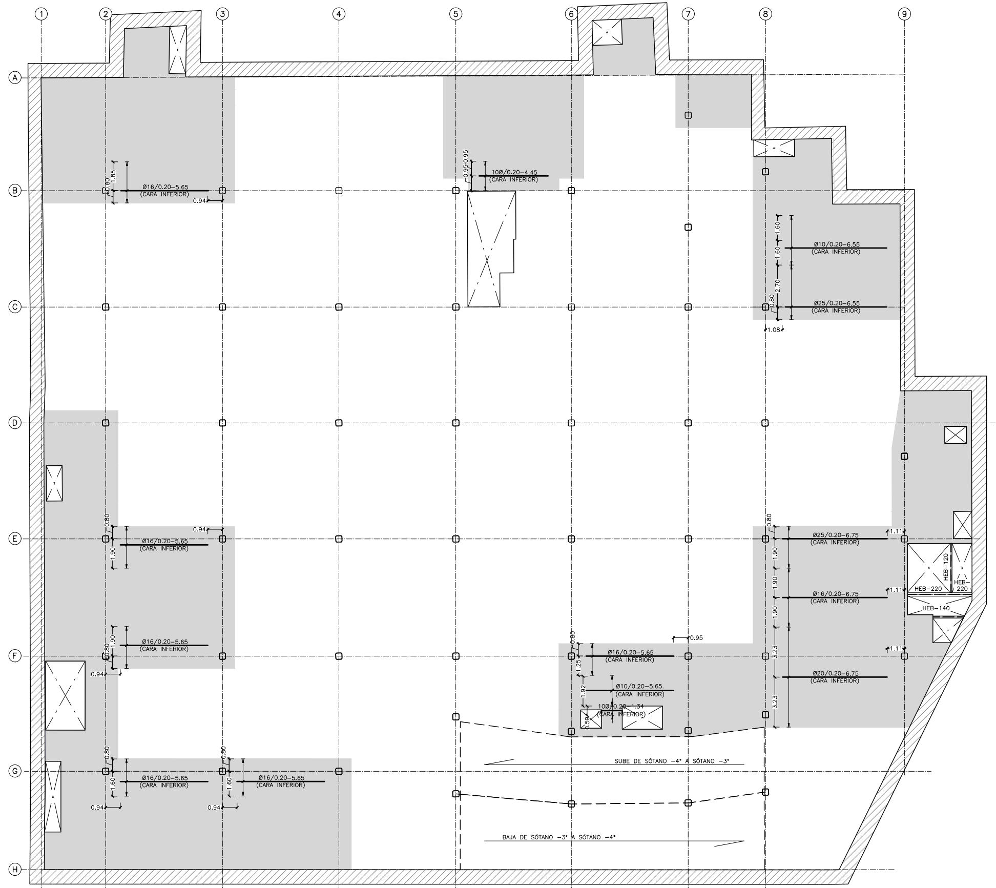
FORJADO SÓTANO -3 REFUERZOS INFERIORES EN DIRECCIÓN X ESCALA 1:250 (NOTA: TODAS LAS COTAS ESTÁN EN METROS)
